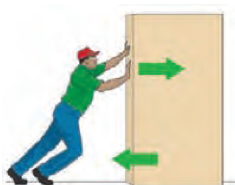
شکل ۲ - شخصی به جعبه ساکن نیرو وارد می کند ولی جعبه حرکت نمی کند (زیرا نیروی روبه جلوی شخص با نیروی روبه عقب اصطکاک هم اندازه اند).
