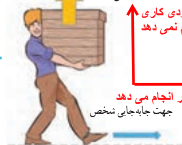
شکل ۴- وقتی نیرو بر جهت جابه جایی عمود باشد، کاری انجام نمی دهد.
