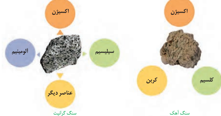
شکل ۴-۵. مقایسه عناصر تشکیل دهنده سنگ گرانیت و سنگ آهک
